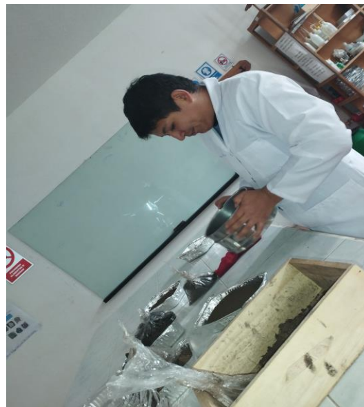
Anexo C. Tamizado y secado de las muestras recolectadas en campo.
