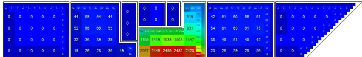
Figura 201. Simulación de niveles de iluminancia en el Bloque A: Operativo (Design Builder, 2023)
