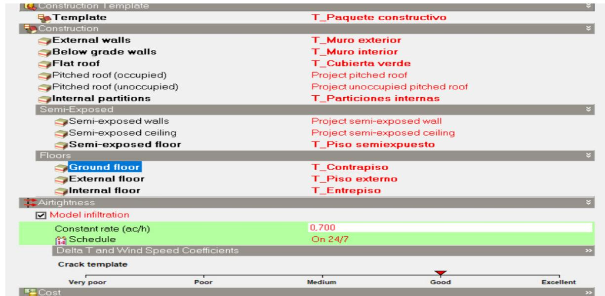
Figura 177. Configuración del paquete constructivo del proyecto en Design Builder (Autores, 2023)
