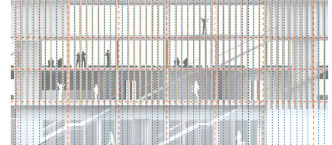
Modulación de la fachada en relación con la estructura
