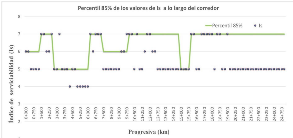
Figura 29: Determinación de tramos homogéneos en base de los resultados del inventario de fallas superficiales en el pavimento flexible.
