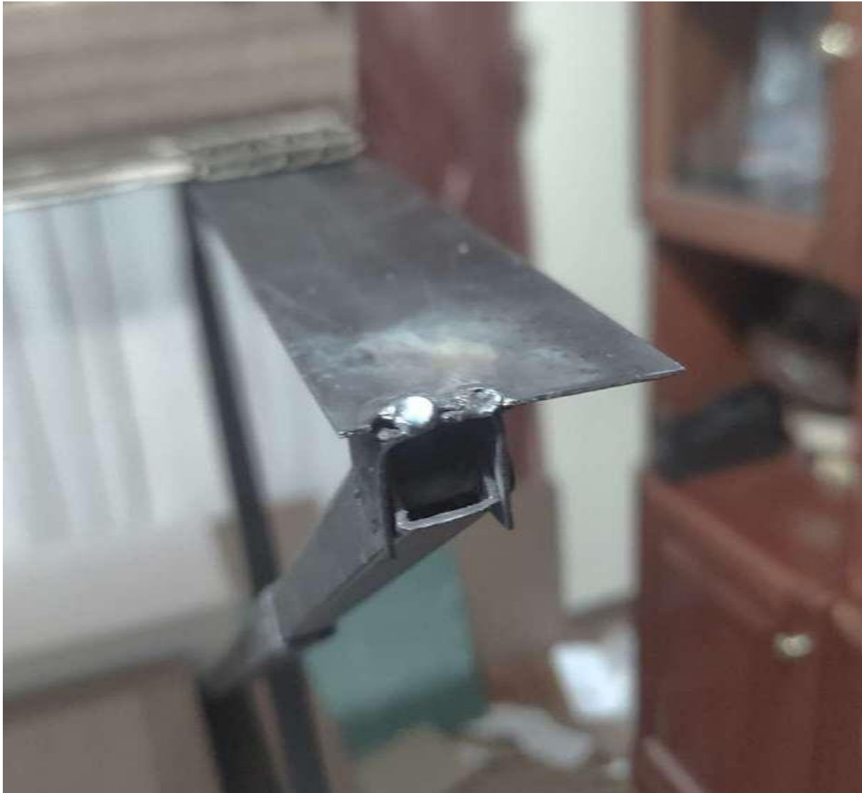
Figura 127. Unión de tijeras a elementos fijos
