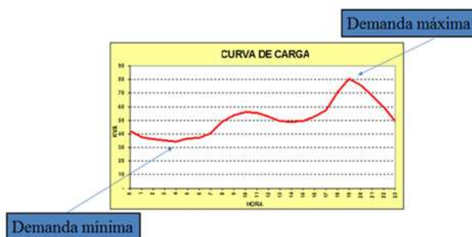
Figura 3: Curva de carga aproximada de un transformador
