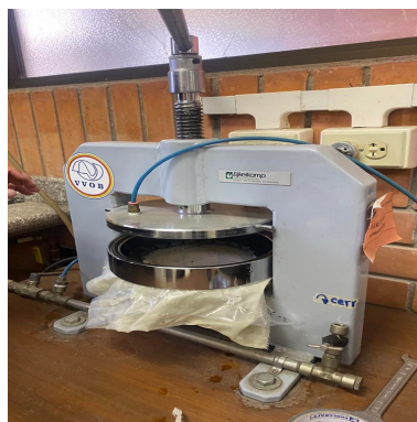
Figura 4. Aparato de membrana de presión
