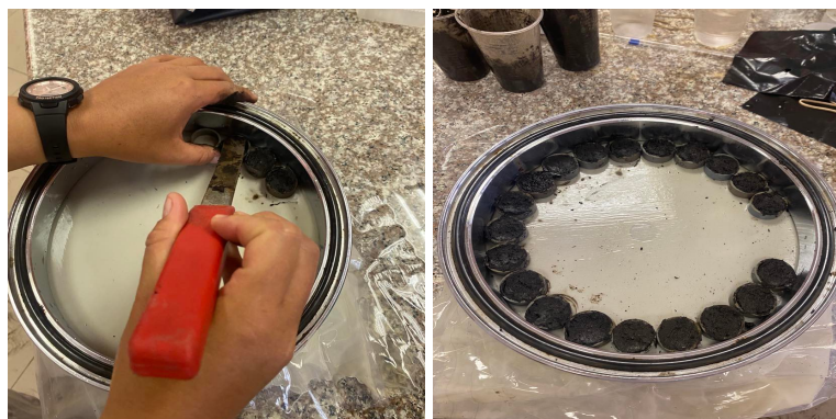
Figura 7. Muestras de suelo en el aparato de membrana de presión
