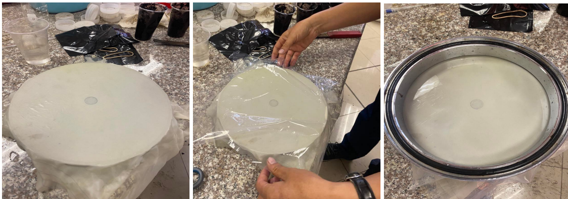
Figura 6. Montaje del aparato de membrana a presión
