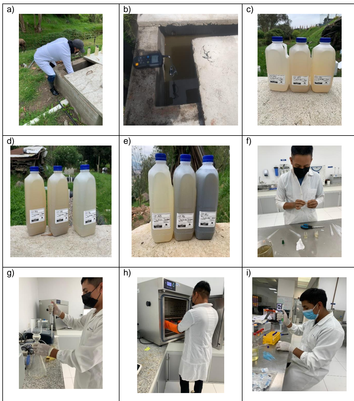
Figura 39. Monitoreo y análisis de laboratorio: a) Toma de muestras de agua en la fosa séptica (M1), b) Análisis in-situ, c) Muestras de agua residual del ST1, d) Muestras de agua residual del ST2, e) Muestras de agua residual del ST3, f) Determinación de fosfatos, g) y h) Determinación de sólidos suspendidos y i) Determinación de amonio.
