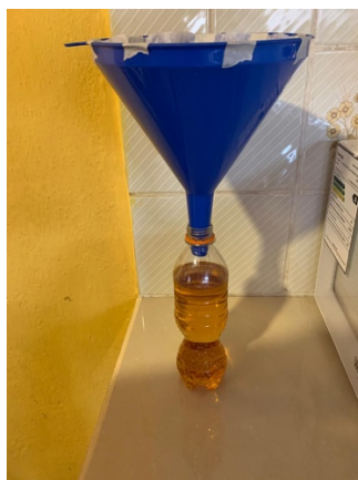
Figura 3. Biocombustible obtenido luego del proceso de filtrado
