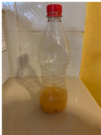
Figura 3. Biocombustible obtenido luego del proceso de filtrado
