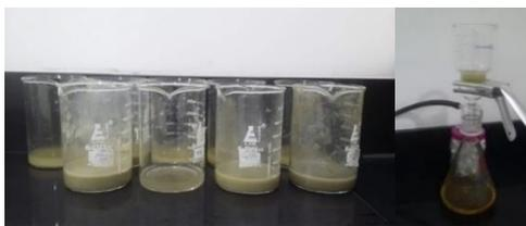
Figura 12 Filtración al vacío.
