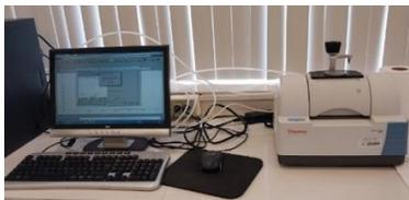
*Figura 16 Equipo de FTIR con módulo ATR.
