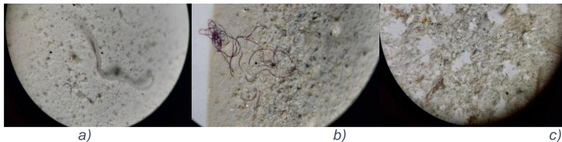
Figura 18 Microplásticos a) gotas y esferas (Pellets), b) fibras y c) fragmentos.
