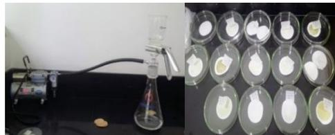
*Figura 8 Filtración al vacío.
