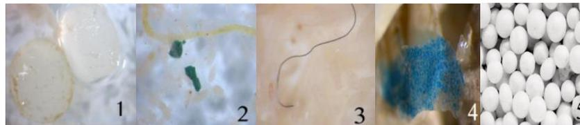
Figura 3 Tipos de MPs: 1) pellet, 2) fragmento, 3) fibra, 4) film y 5) foam.
