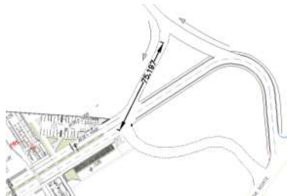
Ilustración 2.36: Distancia de visibilidad para salida desde el equipamiento en el escenario más desfavorable – Alternativa 2; Fuente: Elaboración Propia
