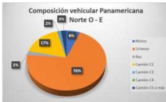
Gráfico 2-11: Composición vehicular del TPDA en acceso Panamericana Norte O – E de intersección B; Fuente: Elaboración propia
