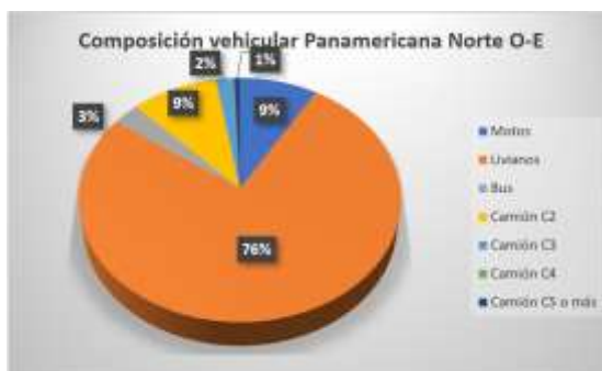
Gráfico 2-2: Composición vehicular del TPDA en acceso Panamericana Norte O – E de intersección A; Fuente: Elaboración propia
