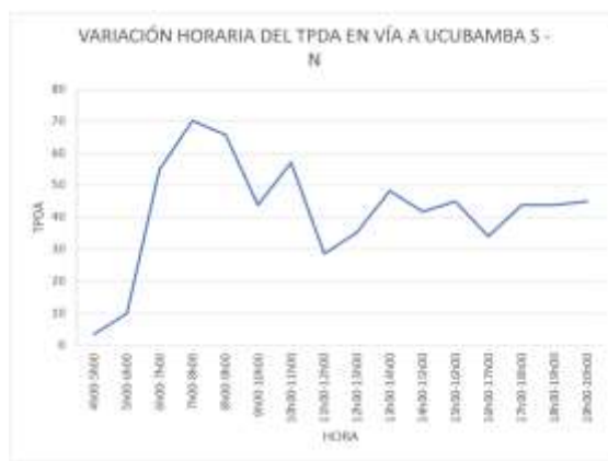
Gráfico 2-34: Variación horaria del TPDA en acceso Vía a Ucubamba S – N de Intersección D; Fuente: Elaboración propia
