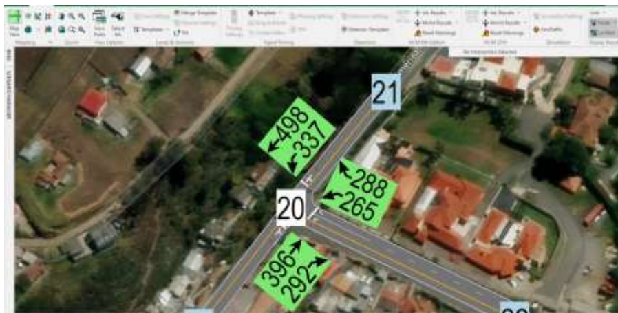
Ilustración 2.81: Volúmenes asignados a cada movimiento en intersección D, con la implementación del proyecto; Fuente: Synchro 11.1
