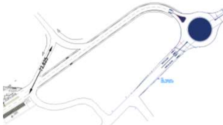
Ilustración 2.35: Distancia de visibilidad para salida desde el equipamiento en el escenario más desfavorable – Alternativa 1; Fuente: Elaboración Propia
