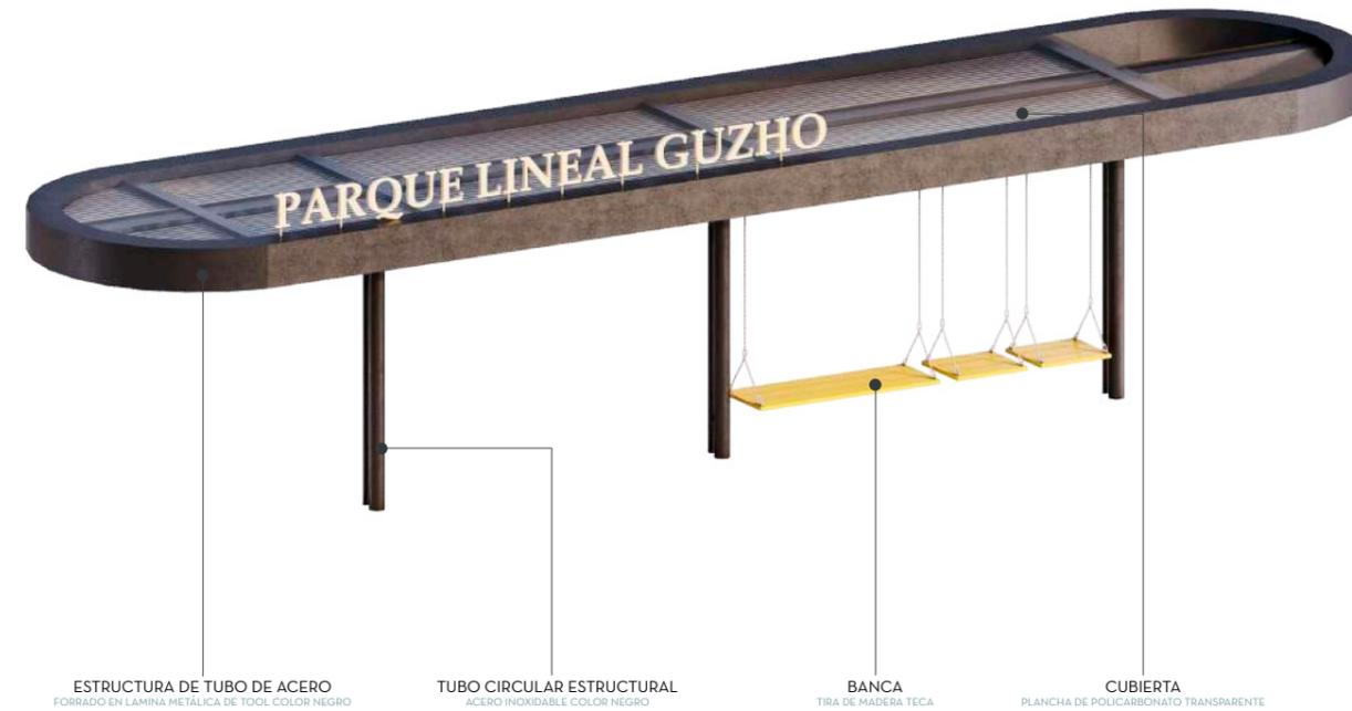
ESTRUCTURA DE TUBO DE ACERO FORRADO EN LAMINA METÁLICA DE TOOL COLOR NEGRO
