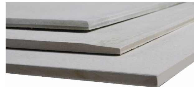
Figura 103: Material de recubrimiento exterior "Fibrocemento"
