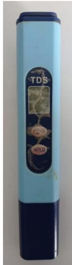
Equipo HACH medidor de Sólidos Disueltos Totales (SDT)
