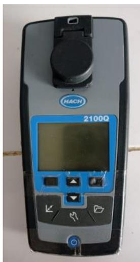
Turbidímetro, marca HACH, modelo 2100 P
