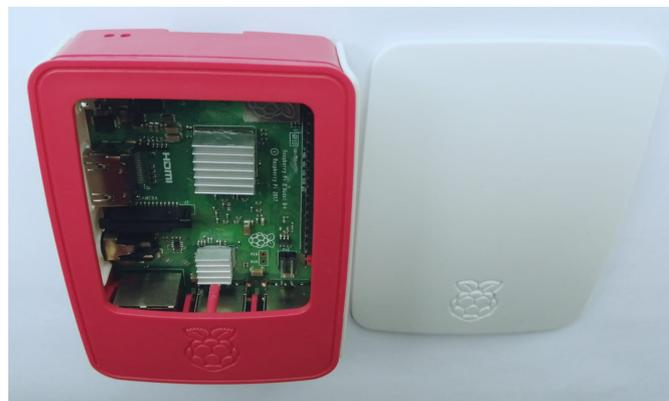
Figura 5.3: Raspberry Pi utilizada
