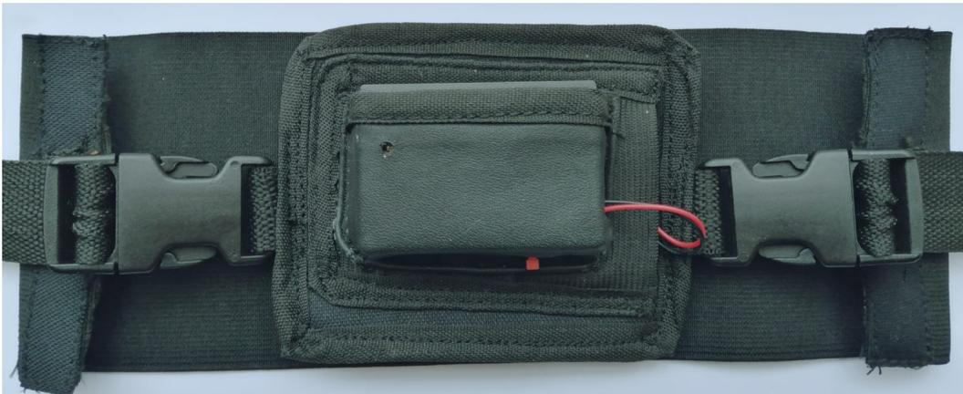
Figura 5.1: Prototipo implementado para la recolección de datos
