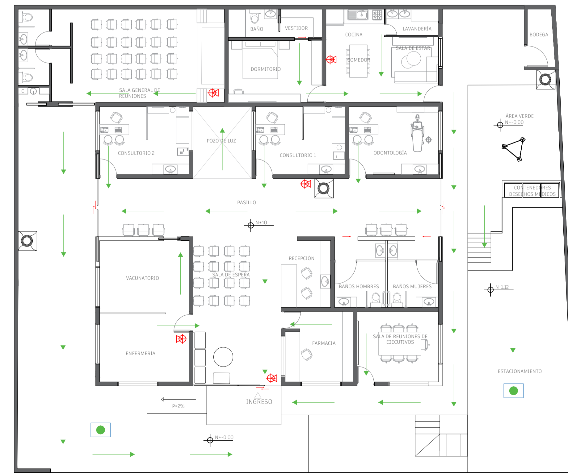
PLANTA DE EVACUACIÓN Y SEGURIDAD
