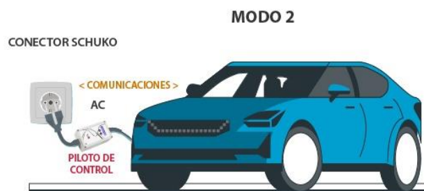
Figura 2.5. MODO DE CARGA 2, Fuente: www.lugenergy.com
