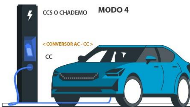
Figura 2.7. MODO DE CARGA 4, Fuente: www.lugenergy.com
