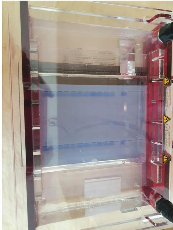
**Anexo 7:** Muestras cargadas en el gel de agar teñido con bromuro de Etidio y corriendo en la cámara de electroforesis
