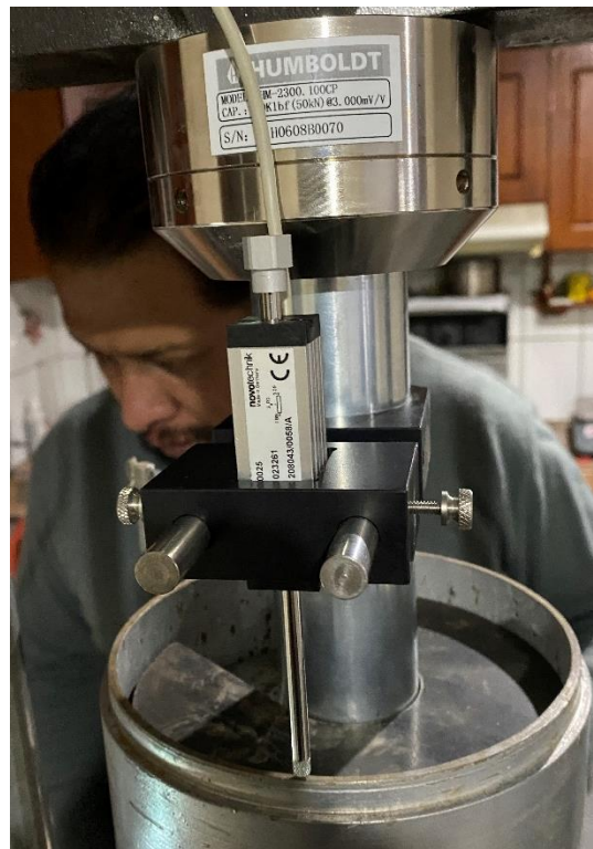
Fig. 4.5 Ensayo CBR. Celda de Carga y Deformímetro.
