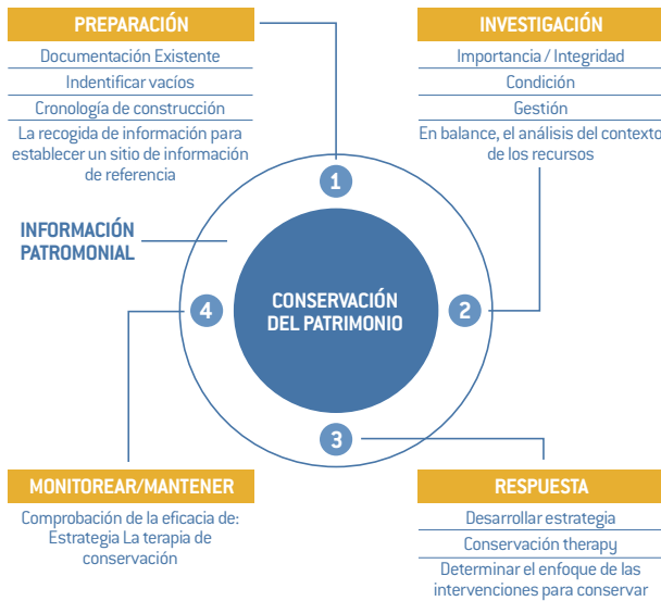
FIGURA 3: Fases en proyectos de conservación, GCI, Demas.
