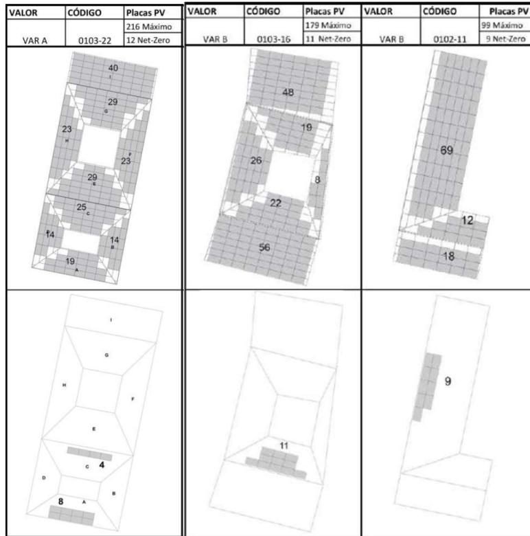
Figura 2. 13 Capacidad geométrica de adaptación PV de paneles de sílice monocristalino en techumbres inclinadas. [5]
