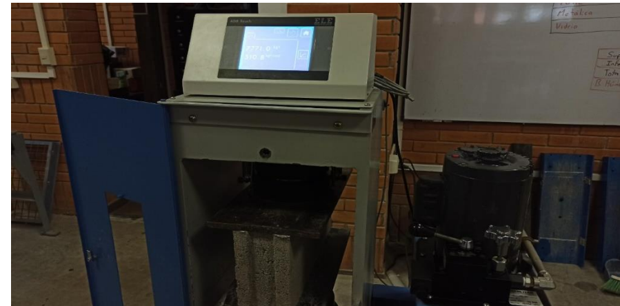
Imagen 4.1.2.3. 1 Ensayo a compresión bloque 10 x 20 x 40.
