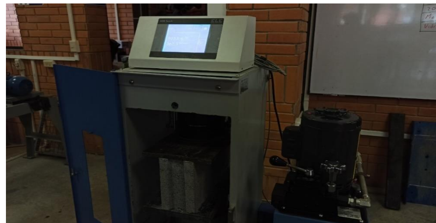
Imagen 4.1.2.4. 1 Ensayo a compresión simple bloque 10 x 20 x 40 cm.
