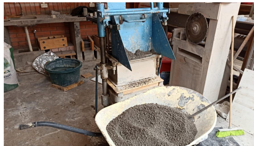
Imagen 3.2.2. 1 Preparación de la mezcla y corrección de dosificación 1:1.24:1.
