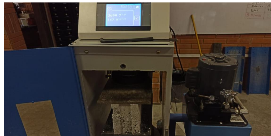
Imagen 4.1.2.1. 1 Ensayo a compresión bloque 10 x 20 x 40 cm.
