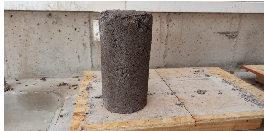
Imagen 3.2.1. 3 Cilindro sometido a esfuerzo a compresión.
