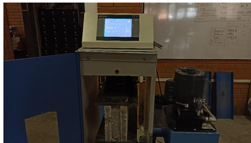
Imagen 4.1.2.2. 1 Ensayo a compresión bloque 10 x 20 x 40.
