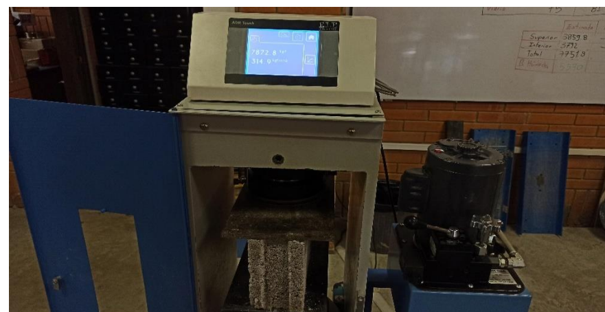
Imagen 4.1.2.4. 2 Ensayo a compresión simple bloque 10 x 20 x 40 cm.
