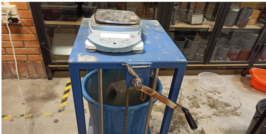
Imagen 4.1.1. 2 Método de sumersión de las muestras de ensayo en agua.
