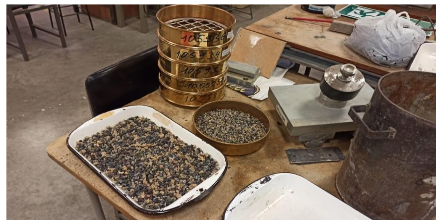
Imagen 3.1.6. 1 Proceso de tamizado del agregado grueso, PET.
