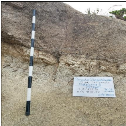
Imagen 30: Estratos existentes en la parte alta (desde la superficie): capa lítica gris arenosa, capa de cascajo blanco y roca madre inicial
