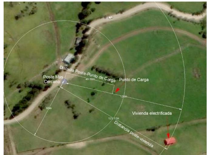
Figura 9 Análisis del radio de cobertura partiendo de un poste
