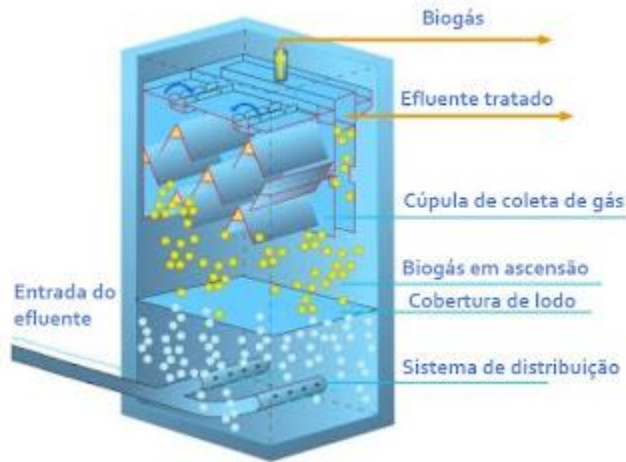
Ilustración 5 Funcionamiento de un RAFA
