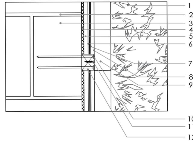
● Subdetalle 1: Union de Estructura Metálica a Pared
