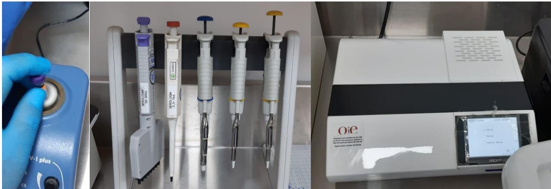
Imagen 1. Equipos utilizados para el trabajo de campo, en donde tenemos de izquierda a derecha: vortex, micropipetas y analizador de ácidos nucleicos
