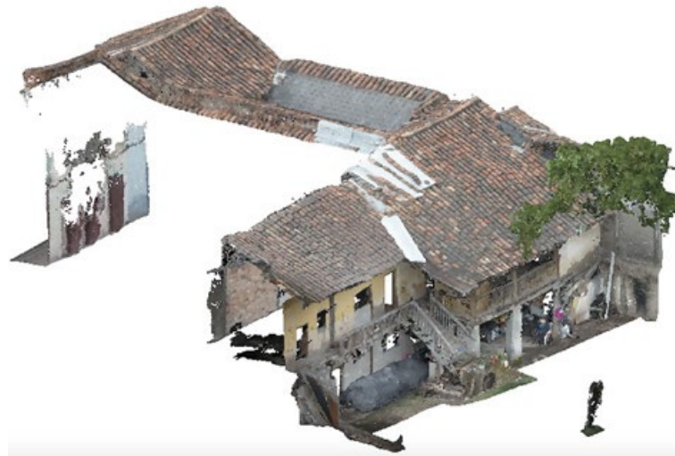
Figura 59. Nube de Puntos obtenida del Levantamiento Aéreo
