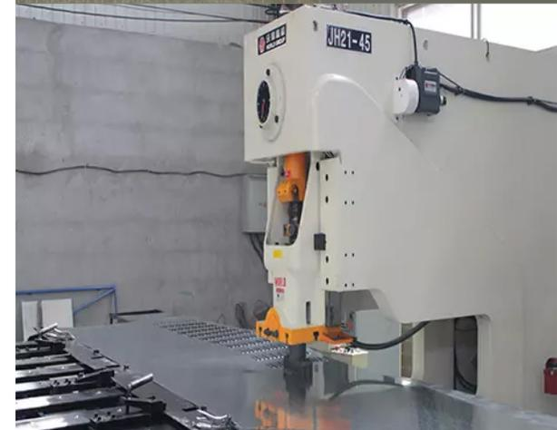
Imagen 045: Elaboración de la malla metálica por medio del estampado (perforación).
