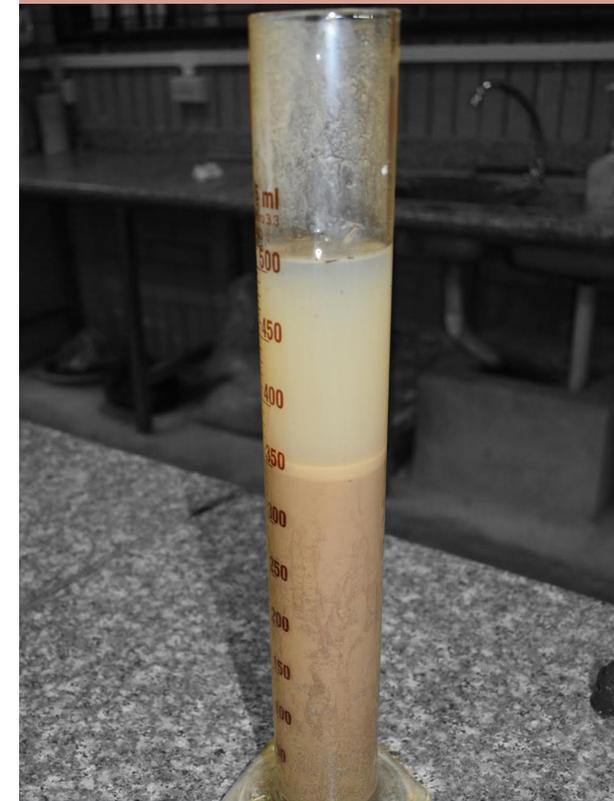
Imagen 059. Ensayo de Sedimentación.
