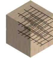
**Tesis:** Reforzamiento del adobe con malla metálica para el mejoramiento de las condiciones resistentes.
