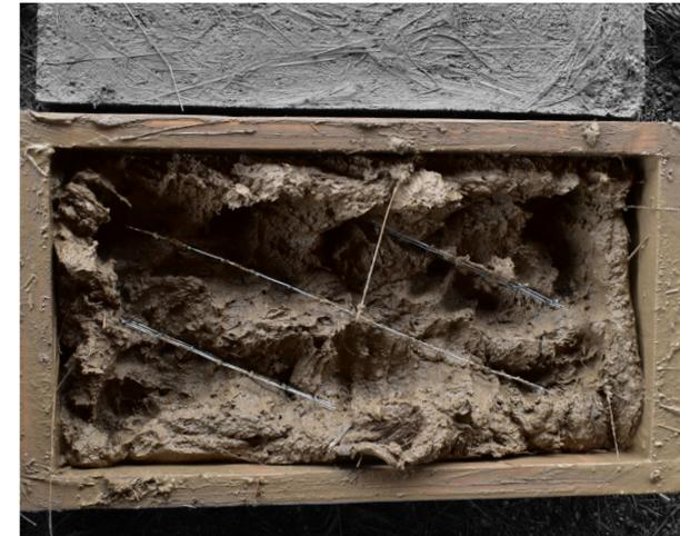
**Imagen 093.** Colocación diagonal de las tres mallas metálicas.
