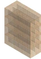
**Tesis:** mejoramiento del adobe con malla metálica para el mejoramiento de las condiciones resistentes.
