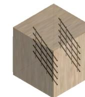
**Tesis:** Reforzamiento del adobe con malla metálica para el mejoramiento de las condiciones resistentes.
