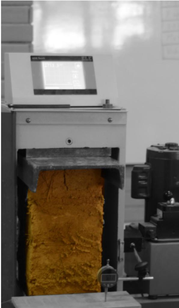
Imagen 104. Ensayo de murete a compresión.
