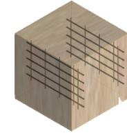
**Tesis:** Reforzamiento del adobe con malla metálica para el mejoramiento de las condiciones resistentes.
