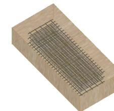
**Tesis:** Reforzamiento del adobe con malla metálica para el mejoramiento de las condiciones resistentes.
