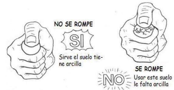
**Imagen 035:** Ensayo de la resistencia seca.
