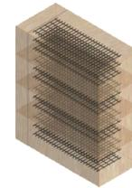
**Tesis:** Reforzamiento del adobe con malla metálica para el mejoramiento de las condiciones resistentes.
