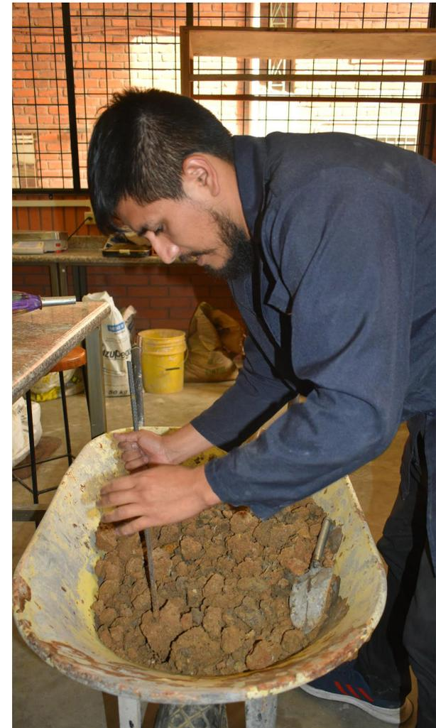
**Imagen 056.** Preparación de la tierra para las pruebas de campo y laboratorio.
