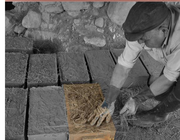
**Imagen 094.** Colocación de paja para el sellado de la pieza.
