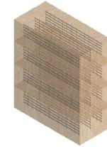
Tesis: Reforzamiento del adobe con malla metálica para el mejoramiento de las condiciones resistentes.
