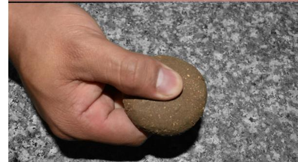
Imagen 061. Ensayo de resistencia seca.
