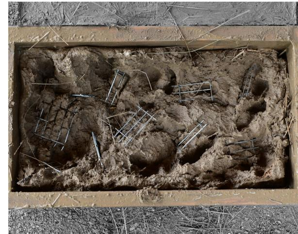
**Imagen 095.** Colocación de varias piezas pequeñas de malla metálica.
