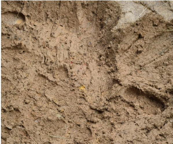
**Imagen 003:** Masa de barro formado con tierra, agua y paja para la elaboración del adobe.
