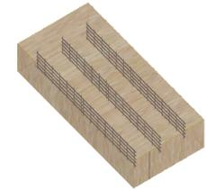
**Tesis:** Reforzamiento del adobe con malla metálica para el mejoramiento de las condiciones resistentes.
