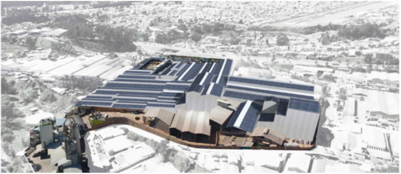
Figura 69. Fotomontaje de fotovoltaicos en techumbre de industria analizada [233].
