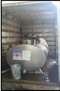
Imagen 8. Transporte de leche en tanque de acero inoxidable
