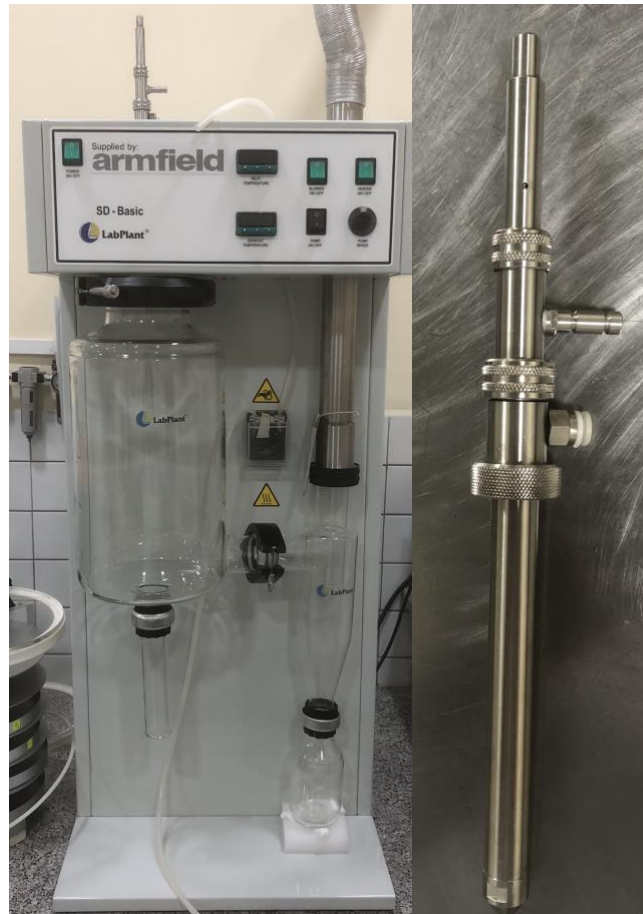
Figura 8. Equipo de secado y boquilla de atomización.
