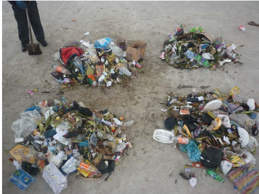
Fig. No. 10.- Utilización del método del cuarteo para clasificar los residuos sólidos.
