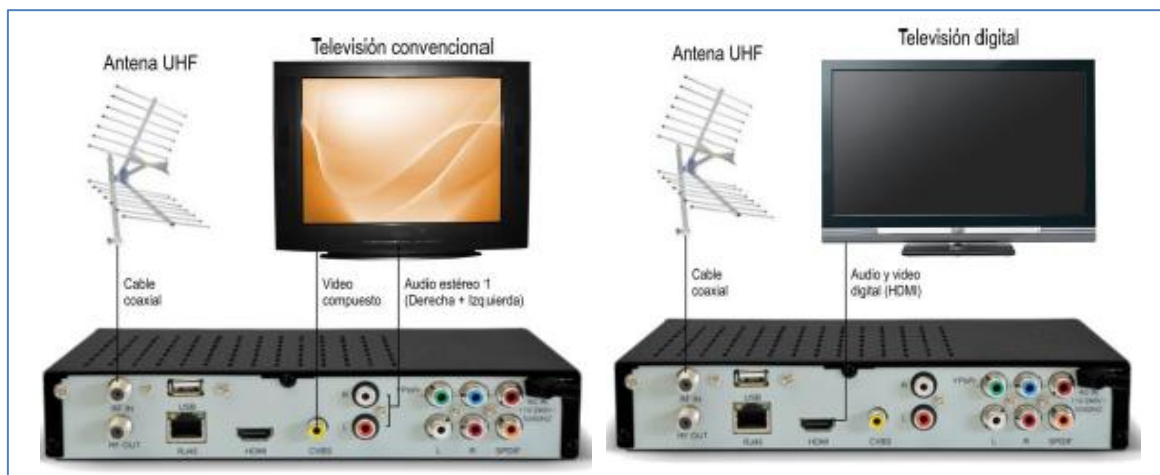
Figura 5- 47. Instalación del equipo de recepción
