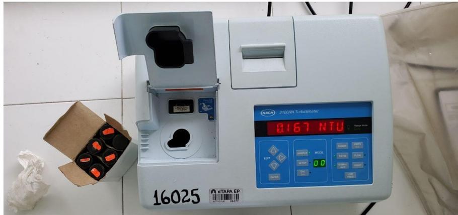
Figura 14: Turbidímetro marca HACH junto a sus patrones para establecer la curva de calibración.
