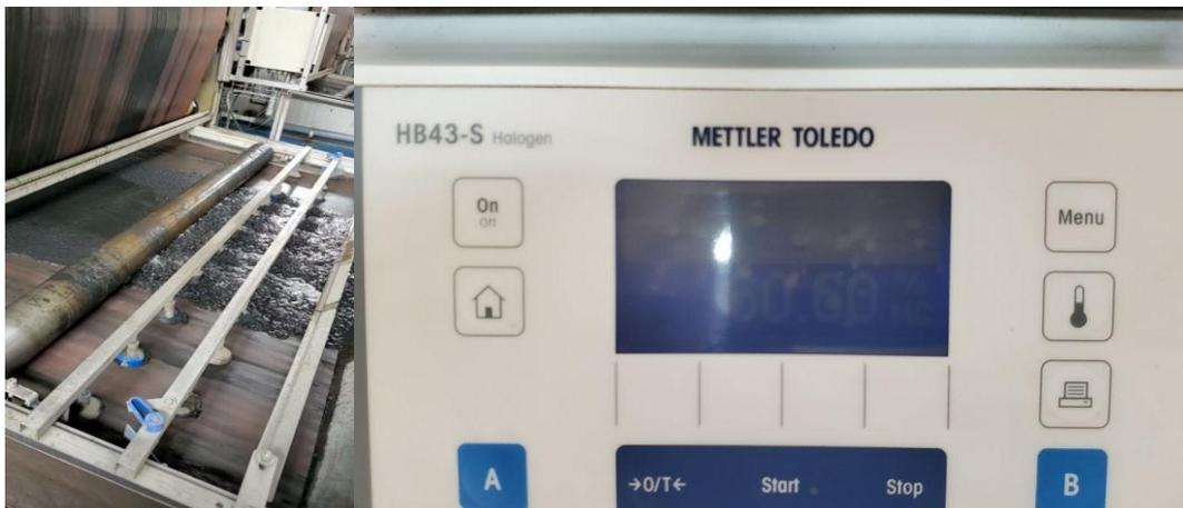
Figura 41: Floculación con AKA 8400 y porcentaje de humedad en el lodo resultante.
