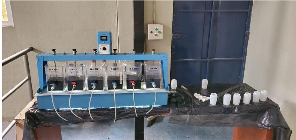
Figura 12: Equipo de prueba de jarras en pleno funcionamiento.
