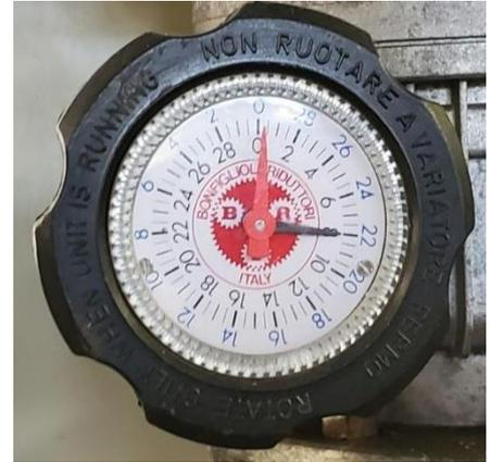
Figura 39: Ejemplo para conocer la concentración a la cual se está preparando la dilución en el tanque preparador de floculante líquido.
