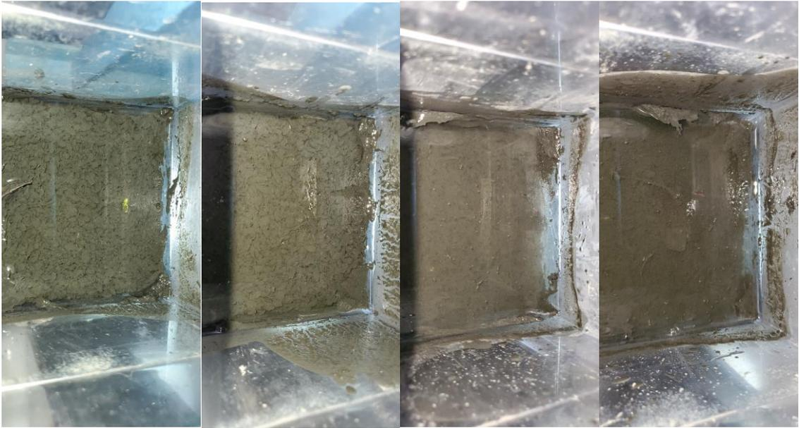
*Figura 28: Resultados obtenidos con el floculante FLOPAM 830 a diferentes concentraciones.*
