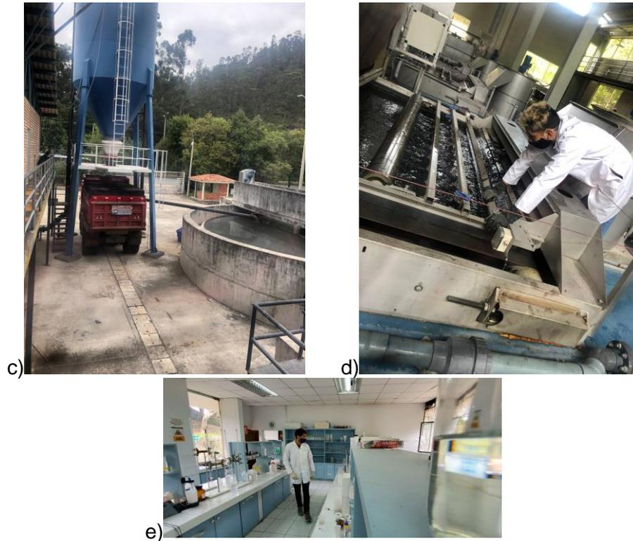
*Figura 5: a) Laguna Facultativa #1, b) 2 tanques sedimentadores y 1 tanque de almacenamiento de lodos espesados, c) Silo de 60m<sup>3</sup> de capacidad en proceso de descarga, d) Funcionamiento de filtros banda 2 y 3 dentro de la planta de deshidratación de lodos, e) Laboratorio principal de la planta de tratamiento de aguas residuales de Ucubamba.*
