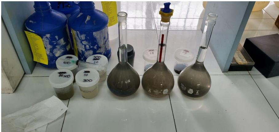
*Figura 13: Muestras de sobrenadantes y sus respectivas disoluciones previo a la medición de turbiedad.*
