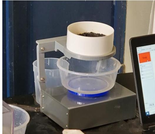
*Figura 15: Equipo de filtración y balanza.*
