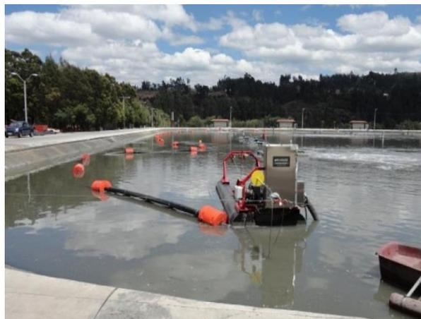
Figura 22: Draga flotante.
