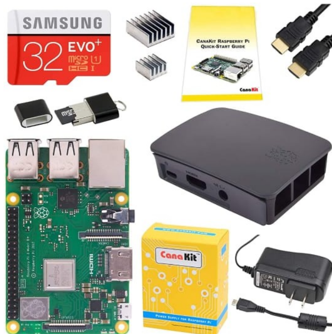
Figura 4.2: Conjunto Raspberry Pi 3B+.
