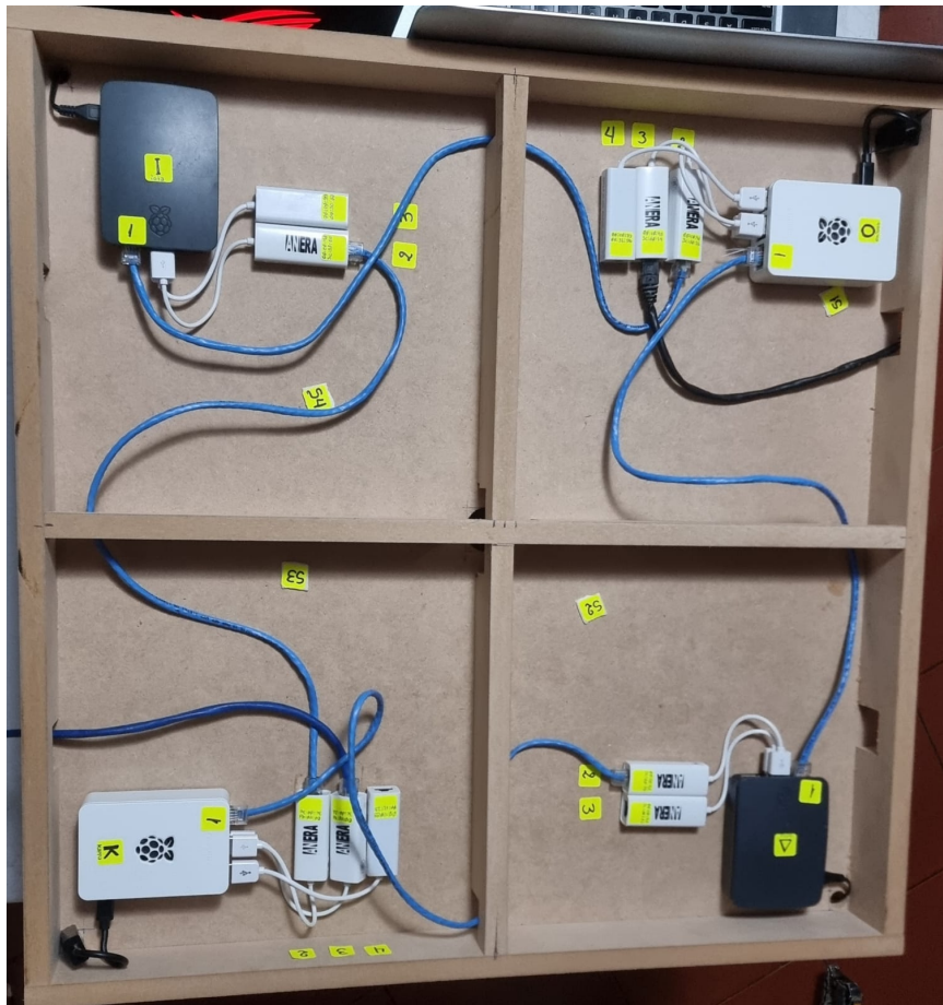
Figura 5.15: Laboratorio para SDN de menor escala con Raspberry Pi
