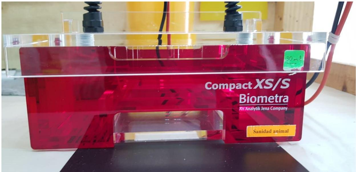
**Anexo 16.** Gel agar con tinción de bromuro de Etidio preparado y colocado en cámara de electroforesis
