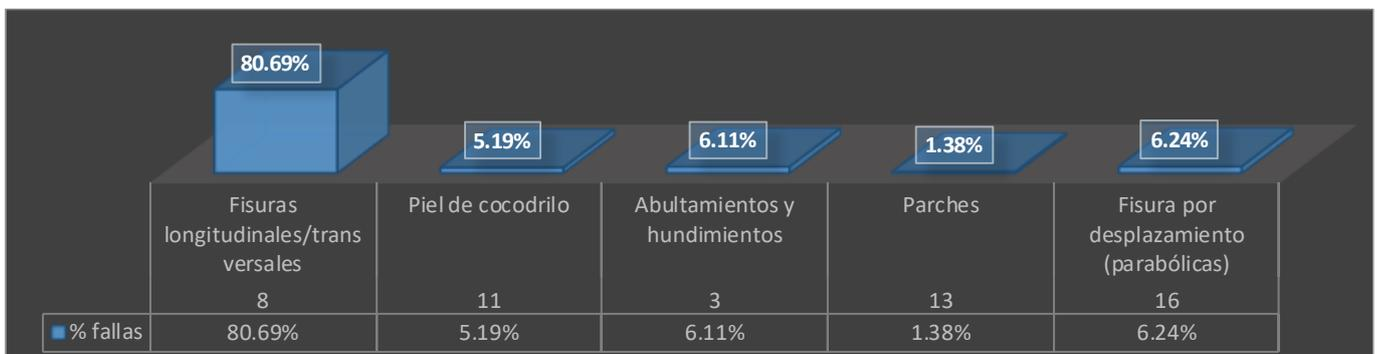
Figura 62: Porcentaje de fallas existentes en el tramo adicional 6.
