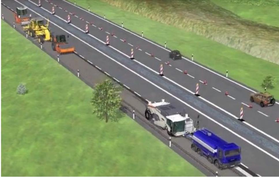
Figura 85: Tren de trabajo para fresado más estabilización con emulsión (Wirtgen GmbH, 2004a).
