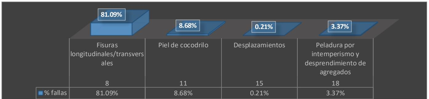
Figura 65: Porcentaje de fallas existentes en el Tramo adicional 9.
