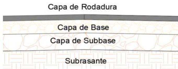
Figura 3: Estructura de un pavimento flexible (Elaboración propia).
