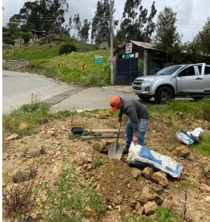
Figura 33: Obtención de muestra de suelo para realizar ensayos, abscisa 4+792.
