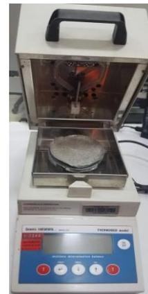
*Ilustración 30. Balanza térmica.*
