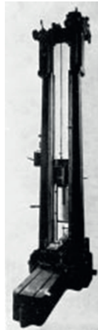
Fig. 34 Máquina de impacto Hatt-Turner, ilustrando el método de realización de la prueba de flexión por impacto.
