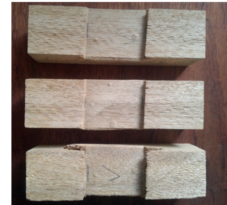
Fig. 68 Foto de ensayo perpendicular a la fibra Llorá Sangre. Fuente: David Valdez
