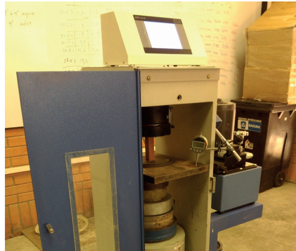
Fig. 73 Ensayo paralelo a la fibra Cuero de Sapo. Fuente: David Valdez
