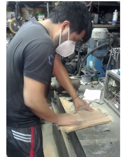
Fig. 100 Lijado de las muestras para catálogo. Fuente: David Valdez
