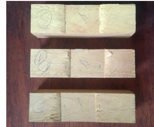
Fig. 64 Foto de ensayo perpendicular a la fibra Pitiuca. Fuente: David Valdez
