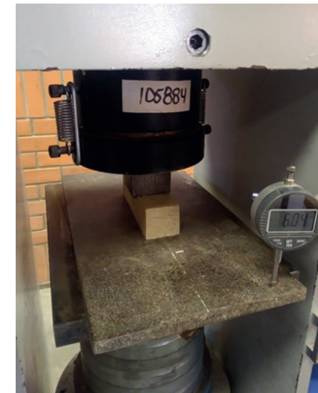
Fig. 58 Foto de ensayo perpendicular a la fibra. Fuente: David Valdez
