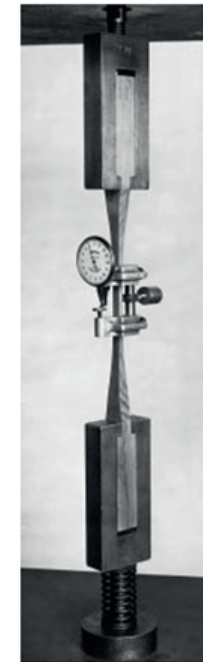
Fig. 35 Ensamblaje de prueba de tensión paralela al grano que muestra los agarres y el uso de un extensómetro de longitud calibrada de 50 mm (2 pulg.) Para medir la deformación.
