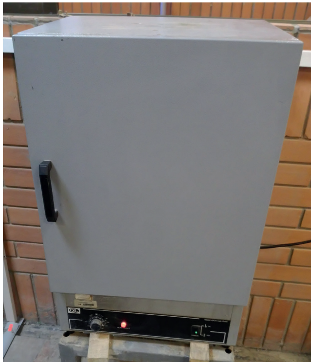
Fig. 54 Foto del horno Model 40 GC Series Lab Ovens. Fuente: David Valdez
