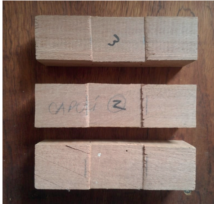
Fig. 66 Foto de ensayo perpendicular a la fibra Capulí. Fuente: David Valdez
