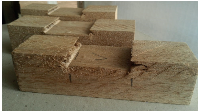
Fig. 67 Foto de ensayo perpendicular a la fibra Llorá Sangre. Fuente: David Valdez
