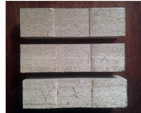
Fig. 60 Foto de ensayo perpendicular a la fibra Cuero de Sapo. Fuente: David Valdez
