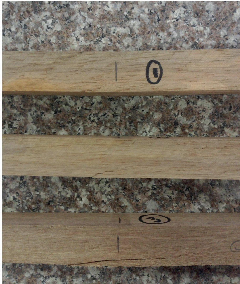
Fig. 92 Tipo de falla especie Yaso Fuente: David Valdez
