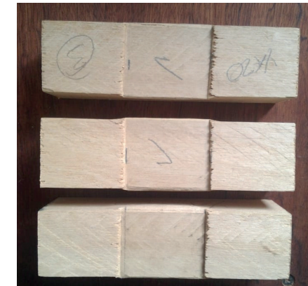
Fig. 70 Foto de ensayo perpendicular a la fibra Yaso. Fuente: David Valdez
