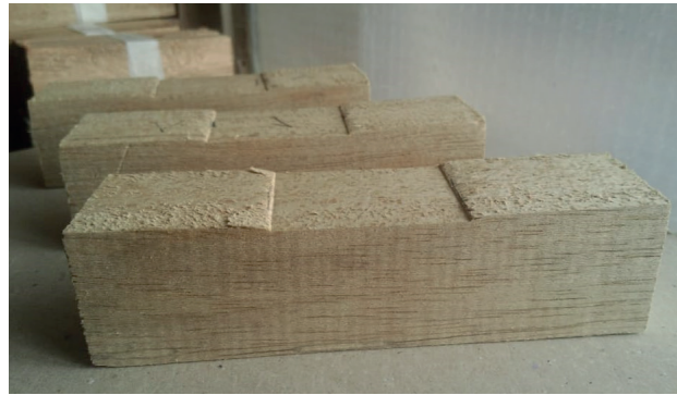
Fig. 59 Foto de ensayo perpendicular a la fibra Cuero de Sapo. Fuente: David Valdez
