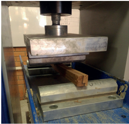
Fig. 80 Ensayo de flexión estática Fuente: David Valdez
