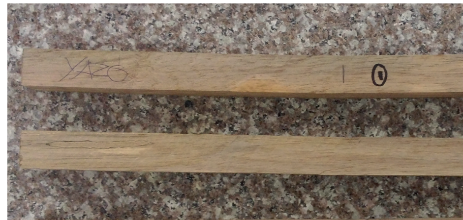
Fig. 93 Tipo de falla especie Yaso Fuente: David Valdez
