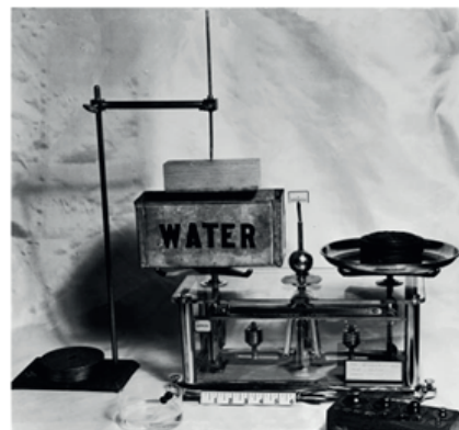
Fig. 33 Configuración de prueba de gravedad específica y contracción en volumen.
