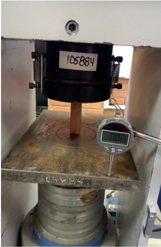
Fig. 72 Foto de ensayo paralelo a la fibra. Fuente: David Valdez
