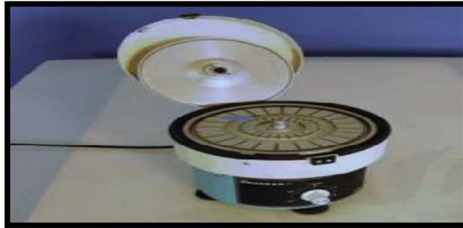
**Figura 6** Microcentrífuga utilizada para el análisis del microhematocrito.
