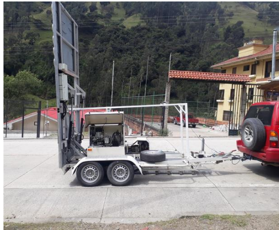
Figura 3.2. Deflectómetro PRIMAX 1500, propiedad del MTO.
