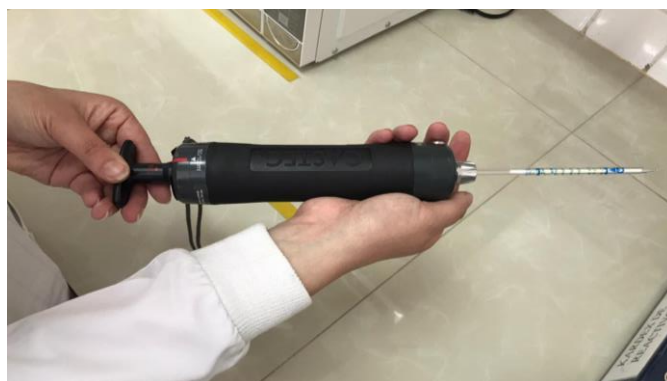
Ilustración 28: Alineación del tubo detector con la bomba.
