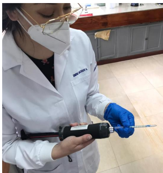
Ilustración 31: Extracción del tubo detector.
