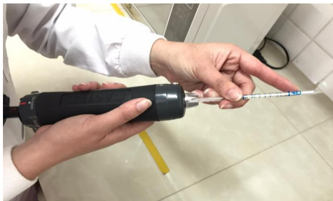
Ilustración 27: Colocación del tubo detector en la bomba.
