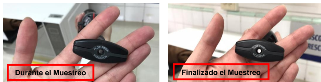
Ilustración 30: Verificación de finalización de bombeo.
