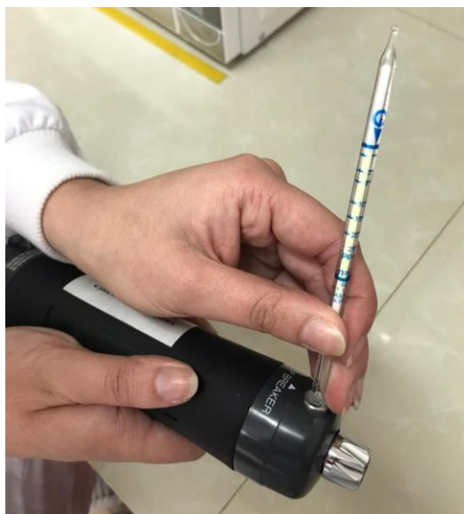
Ilustración 26: Rotura de las puntas del tubo detector.
