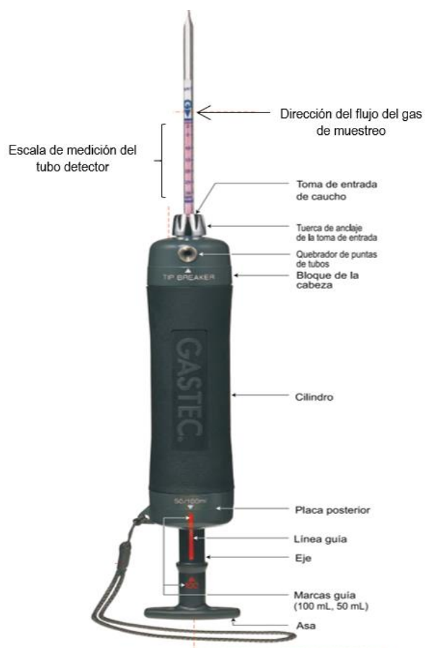
Ilustración 2: Sistema de Detección de Gases: Bomba y Tubo Colorimétrico.
