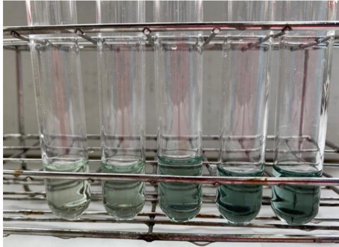
Figura 34. Patrones de ácido gálico para realizar la recta de calibrado del contenido de polifenoles totales. De izquierda a derecha: 20 ppm, 40 ppm, 60 ppm, 80 ppm, 100 ppm.
