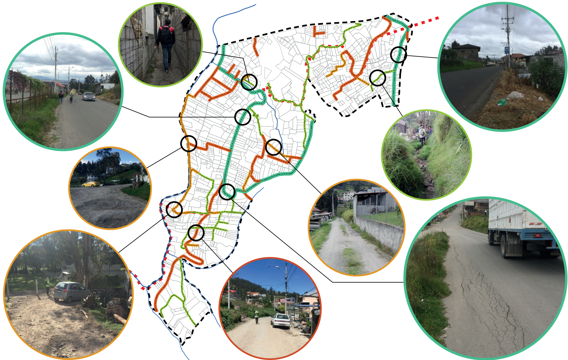
Figura 66: Estado actual del sistema vial en el Area de estudio.
