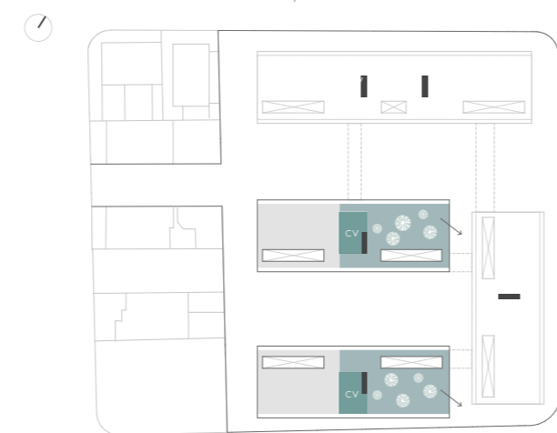
QUINTA PLANTA ALTA: Instalaciones y Área recreativa.
