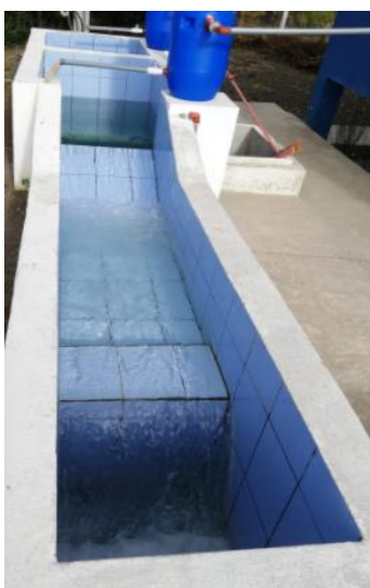
Imagen 5 Resalto Hidráulico y Vertedero rectangular Fuente: Elaboración-Autor
