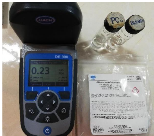
Imagen 23 Equipo para determinación de fósforo. Fuente: Elaboración-Autor
