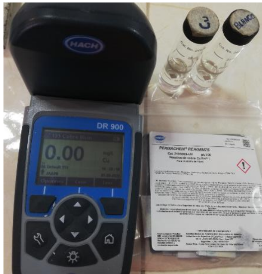
Imagen 21 Equipo para determinación de cobre Fuente: Elaboración-Autor
