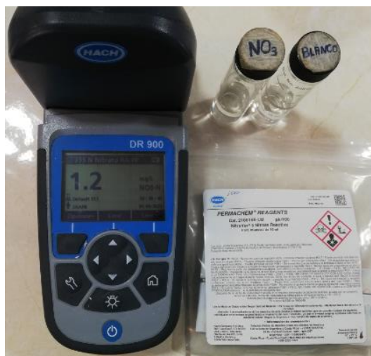
Imagen 25 Equipo para determinación de Nitratos. Fuente: Elaboración-Autor
