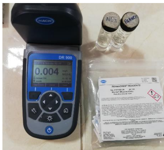
Imagen 26 Equipo para determinación de nitritos. Fuente: Elaboración-Autor
