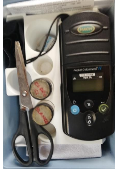
Imagen 40 Equipo para la determinación de cloro residual Fuente: Elaboración-Auto
