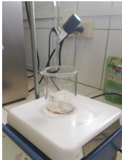
Imagen 14 Equipo para determinación de Alcalinidad Fuente: Elaboración-Autor
