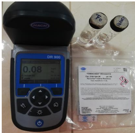
Imagen 24 Equipo para determinación de Hierro. Fuente: Elaboración-Autor
