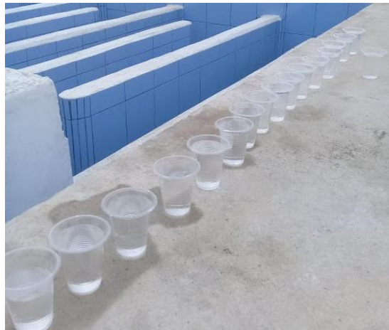
Imagen 33 Toma de muestras para análisis de trazadores. Fuente: Elaboración-Autor
