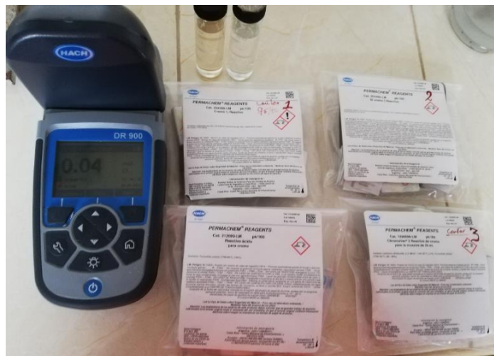
Imagen 22 Equipo para la determinación de Cromo. Fuente: Elaboración-Autor
