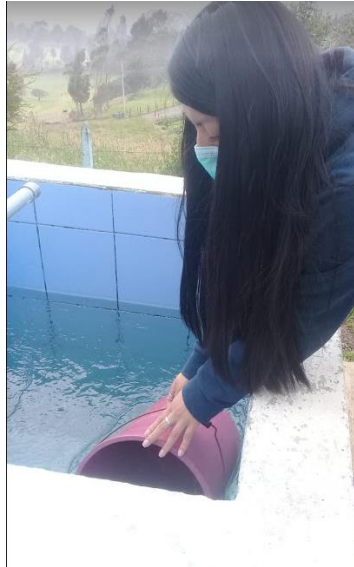
Imagen 13 Toma de muestras a la entrada de la planta. Fuente: Elaboración-Autor
