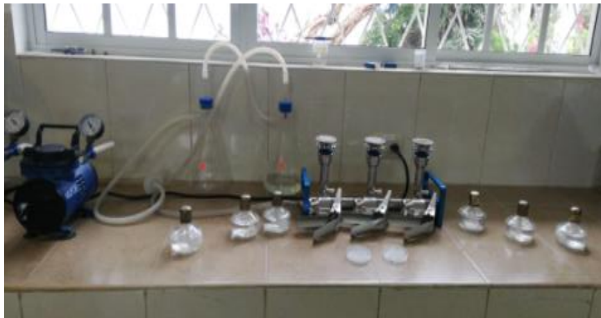
Imagen 30 Equipo para determinación de Coliformes totales y fecales Fuente: Elaboración- Autor
