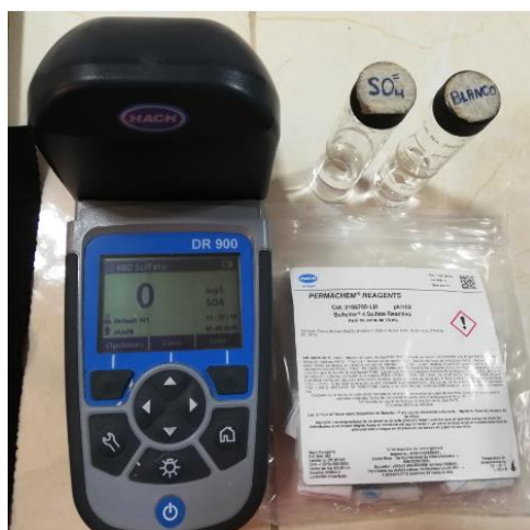
Imagen 28 Equipo para determinación de sulfatos Fuente: Elaboración-Autor
