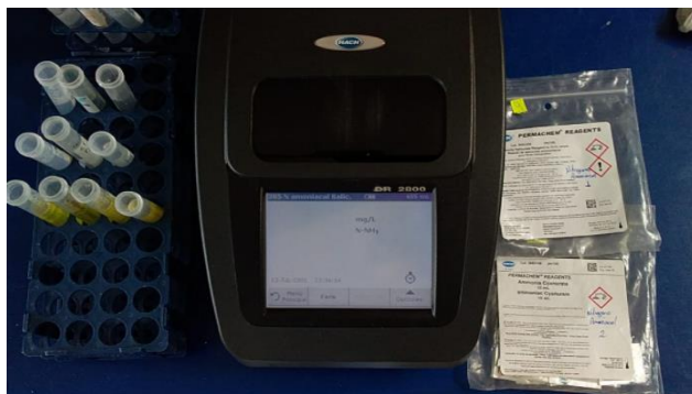
Imagen 27 Equipo para la determinación de Nitrógeno Amoniacal Fuente: Elaboración- Autor
