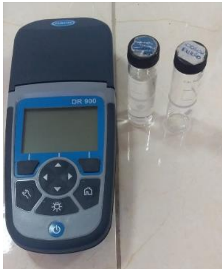
Imagen 15 Equipo para la determinación de color Fuente: Elaboración-Autor
