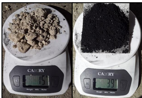
Ilustración 18: Pesado de materias primas Fuente: Autoras
