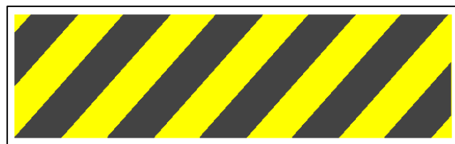
Fig.46. Franja de seguridad para indicar zonas de peligro
