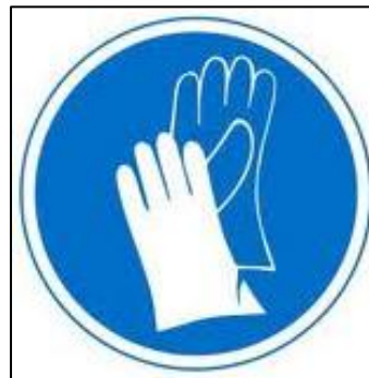
Fig.32. Señal de uso obligatorio de guantes de seguridad
