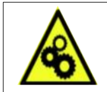
Fig.41. Señal de precaución partes en movimiento
