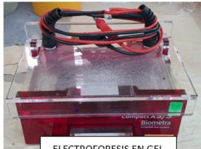
ELECTROFORESIS EN GEL DE AGAROSA PCR
